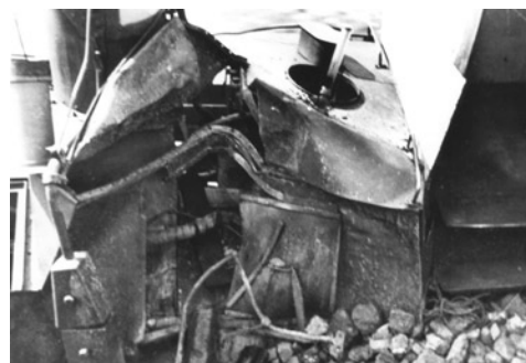
Na skutek zderzenia zniszczeniu uległa nadbudówka kotła.
