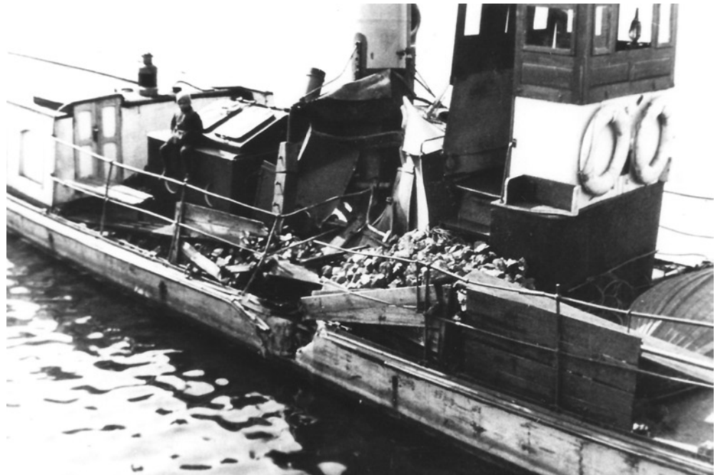
Po staranowaniu przez prom „NEUFÄHRWASSER”, poważnie została uszkodzona prawa burta „BAŁTYKA”.
