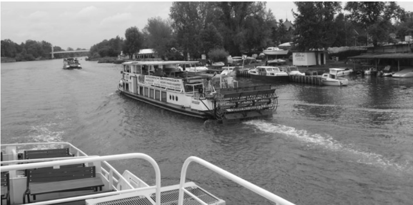
Podczas rejsu, z pokładu S/P „WRATISLAWIA” mieliśmy okazję „podziwiać” zaadoptowany z S/P-150, wyposażony w zblokowane koło łopatkowe pseudo parowiec „NEREIDA”, którego wygląd w założeniach miał zapewne nawiązywać do statków z Missisipi.
